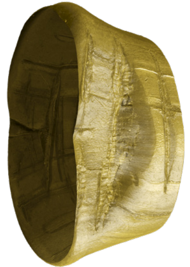
Superfície de projétil deformado
