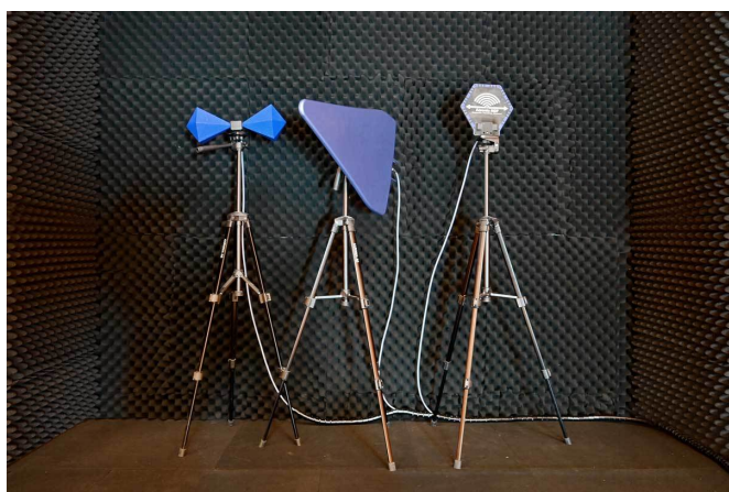
Plně bezodrazová komora EMC, Praha 15, Hostivař
