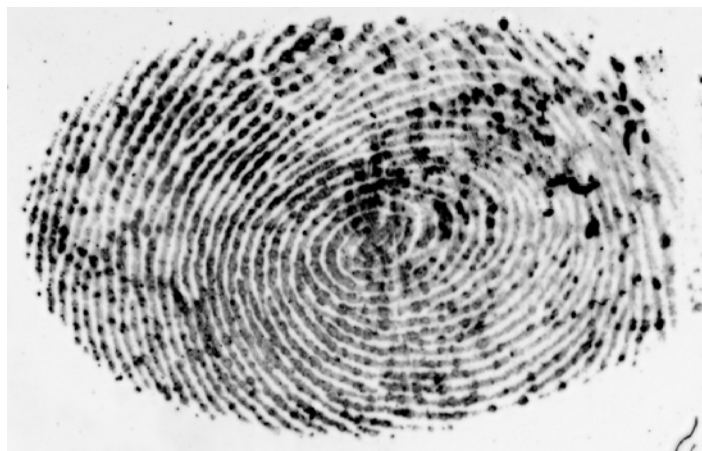
Ślad daktyloskopijny potraktowany polycyano – 365 nm UV z filtrem odcinającym 400 nm.
