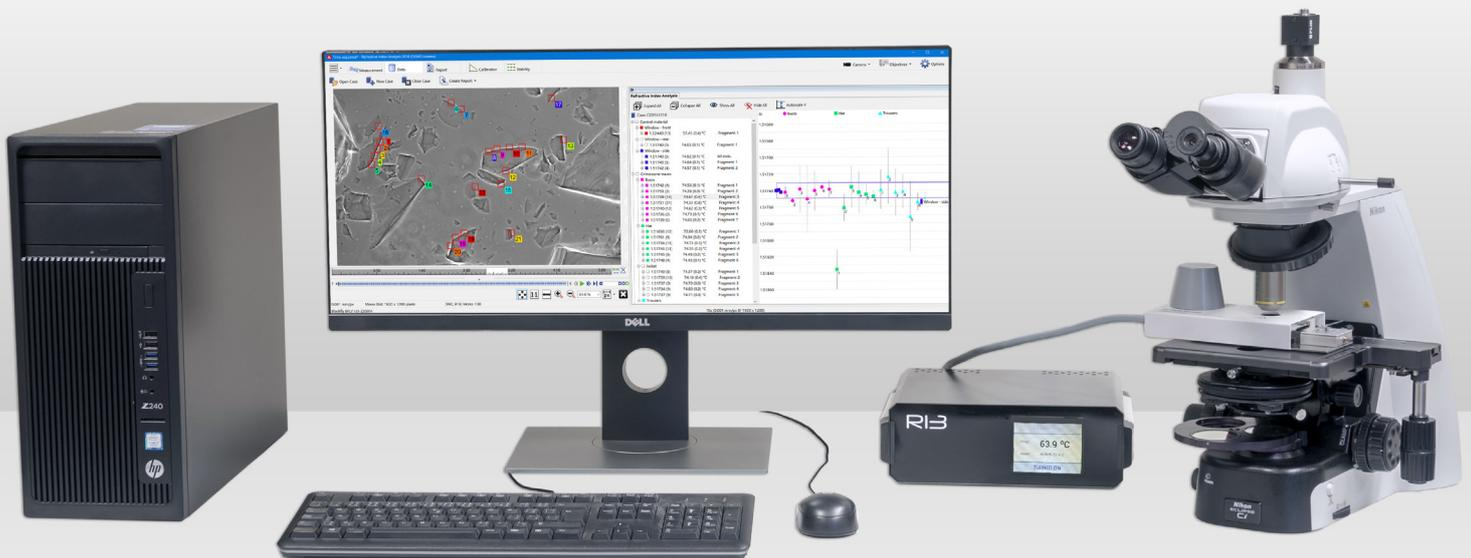
**LUCIA RI** wurde als Komplettlösung für die forensische Analyse von kleinen Glassplittern auf Basis der Immersions-Methode konzipiert. Unser System wurde in enger Zusammenarbeit mit Forensik-Spezialisten der Glas-Analyse entwickelt, um Präzision, Reproduzierbarkeit und einen hohen Komfort bei der Arbeit zu liefern.
