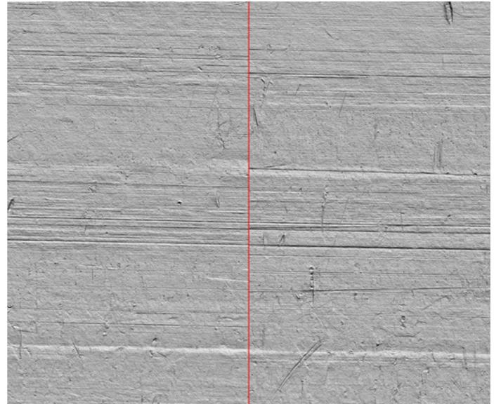
Vergleich von Produktionsmarkierungen auf Oberfläche von 2 Kupferkabelteilen.
